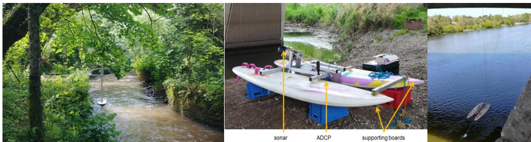
Figure 1 Instrumentations mises en place sur le site de la rivière Aurence (à gauche) et de la Loire (à droite)
